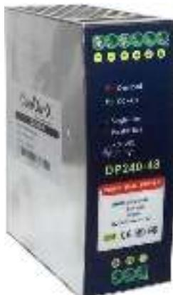
Индустриальный блок питания 48В / 5А (макс. мощность до 240 Вт). Входное напряжение AC 90...264 В, механическая подстройка выходного напряжения 45~55 В, интегрированная защита от перегрузок, коротких замыканий и избыточного напряжения, температурный диапазон -40°C ~ +65°C, вес 840г, размеры 45x121x124 , металл. Устанавливается на DIN-рейку TS-35/7.5 или TS-35/15
