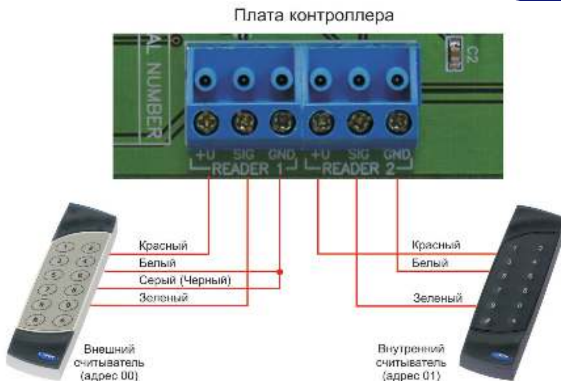
Рисунок 86. Подключение считывателей серии NR-xxx к контроллерам NC-1000/NC-5000.
