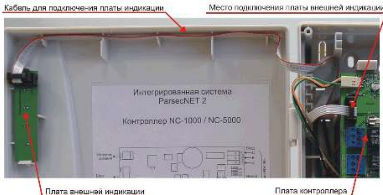
Рисунок 21. Схема подключения платы внешней индикации.
