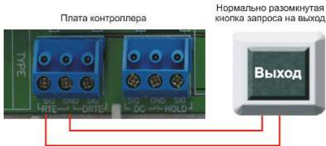
Рисунок 9. Схема подключения кнопки запроса на выход.
