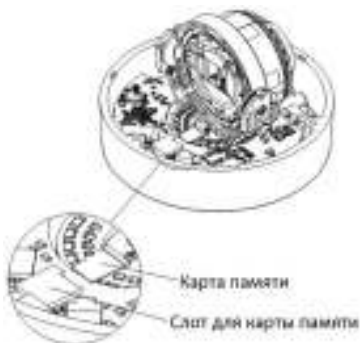
Рисунок 2-3 Установка карты памяти (камера I типа)
