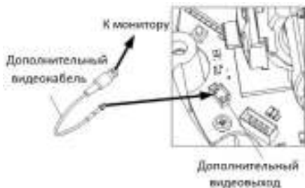
Рисунок 2-31 Подключение камеры к монитору
