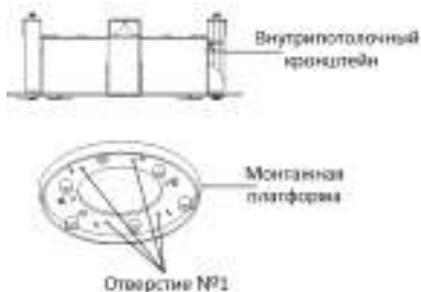
Рисунок 2-13 Установка монтажной платформы
