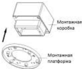
Рисунок 2-28 Установка монтажной платформы
