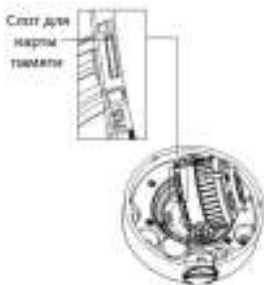
Рисунок 2-4 Установка карты памяти (камера II типа)
