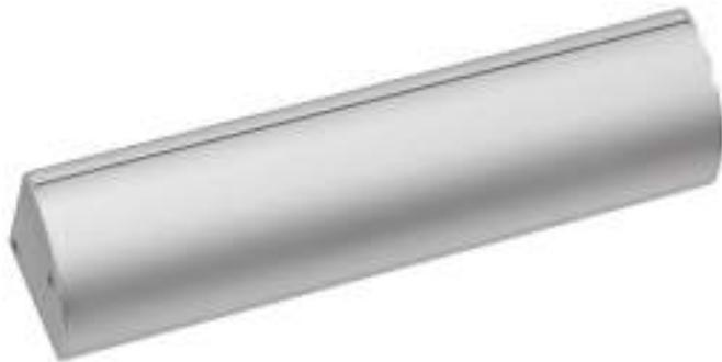
Кронштейн LC типа выполнен из алюминия и предназначен для крепления электромагнитных замков на открывающиеся наружу двери, когда глубина дверной коробки не допускает непосредственный монтаж замка. Кронштейн имеет возможность регулировки выноса замка от двери. Крышка кронштейна позволяет скрыть монтажные элементы замка и проводку, что придает более эстетичный вид входной группе и защищает проводку от преднамеренного повреждения.
