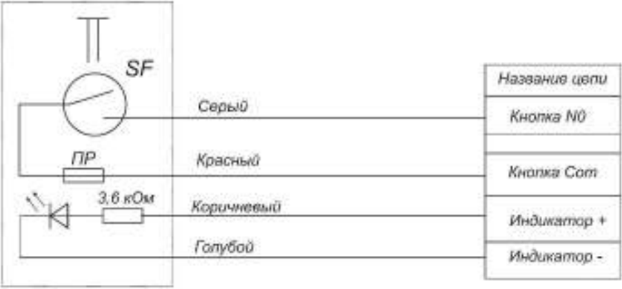
Рисунок 2 – Маркировка выводов изделия AL-BT-S02
