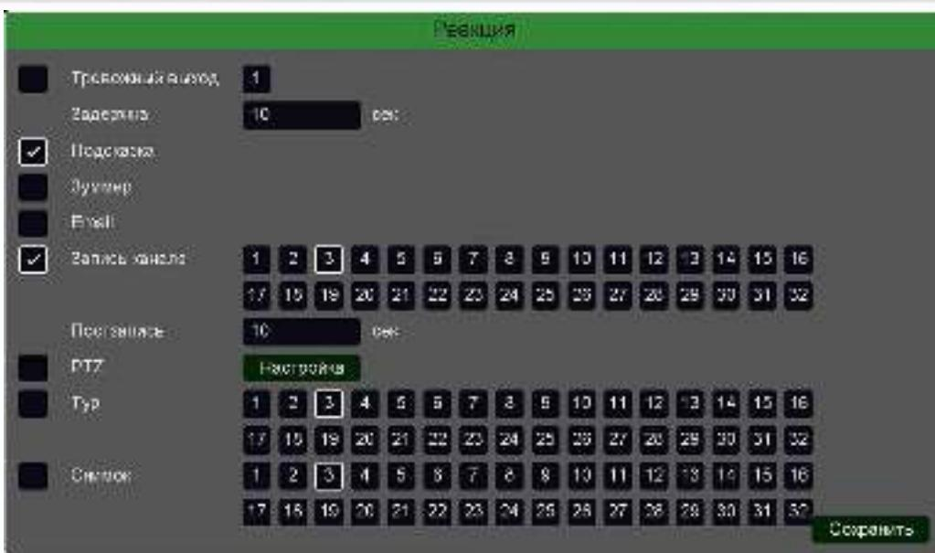
Для включения записи выбранной камеры при детекции движения, необходимо установить галочку  Запись канала и выбрать канал, который будет записываться (на рисунке вверху выбран канал 3). При срабатывании детектора движения камеры можно включить запись не только этой камеры, но и других IP камер.
