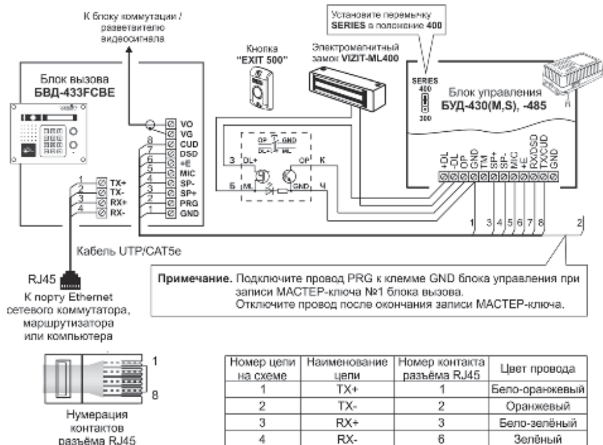
Рисунок 8.2 – Схема соединений блока вызова БВД-433FCBE с блоком управления БУД-430(М,С), -485(М), электромагнитным замком VIZIT-ML400 и кнопкой EXIT 500
