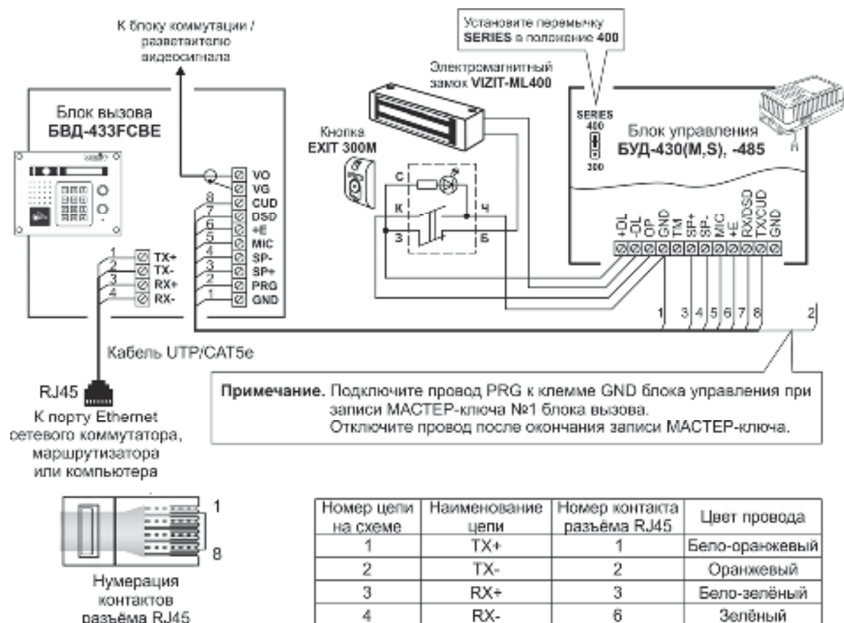
Рисунок 8.1 – Схема соединений блока вызова БВД-433FCBE с блоком управления БУД-430(М,С), -485(М), электромагнитным замком VIZIT-ML400 и кнопкой EXIT 300M
