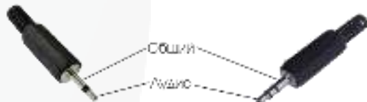
Схема подключения микрофона
