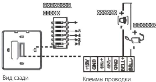
Примечание: При подключении с помощью автономного контроля доступа установите адрес кода набора «1» в положение «ON».
