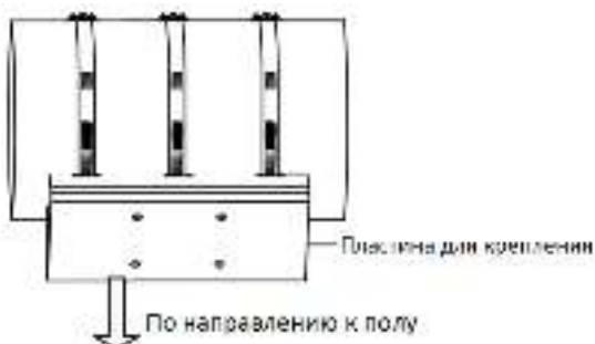
Рисунок 2-5 Установка кронштейна для крепления на столб
