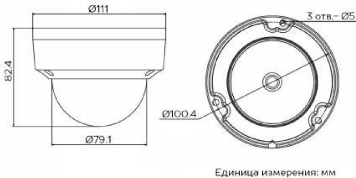
Рисунок 12. Габариты камеры NBLC-2231F-ASD
