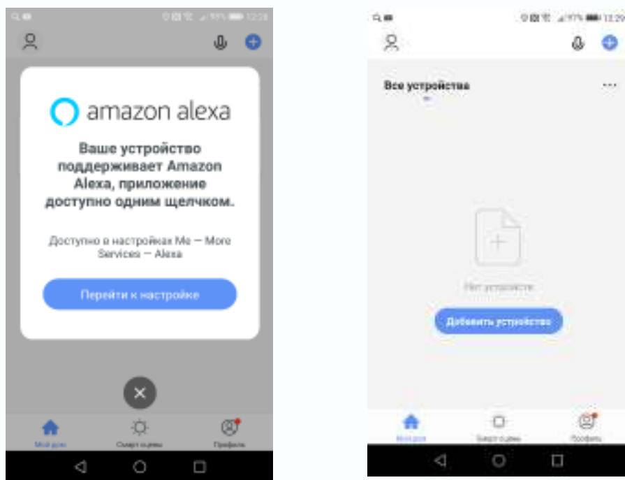
При первом входе список устройств пуст, необходимо добавить камеру в список устройств. Для этого выберите **Видеонаблюдение – Смарт-камера**.
