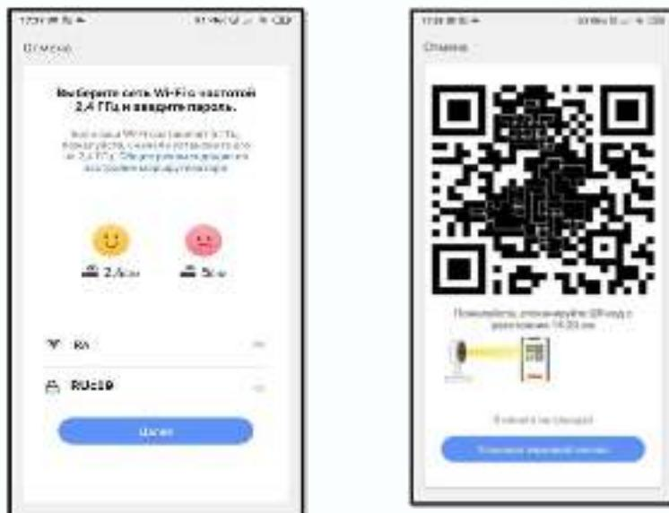
В процессе подключения камера произнесёт «**Connect to router**», а затем «**Connect Internet**». Нажмите «**Услышал звуковой сигнал**».
