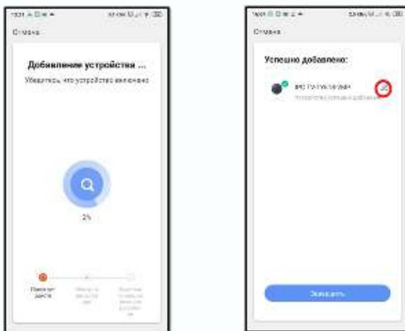
Появится экран с процессом подключения камеры, а следом за ним экран с надписью: «**Успешно добавлено**». При успешном подключении камера произнесет «**Add device success**». Нажав значок редактирования, можно изменить имя устройства. Затем нажмите **Завершить**.
