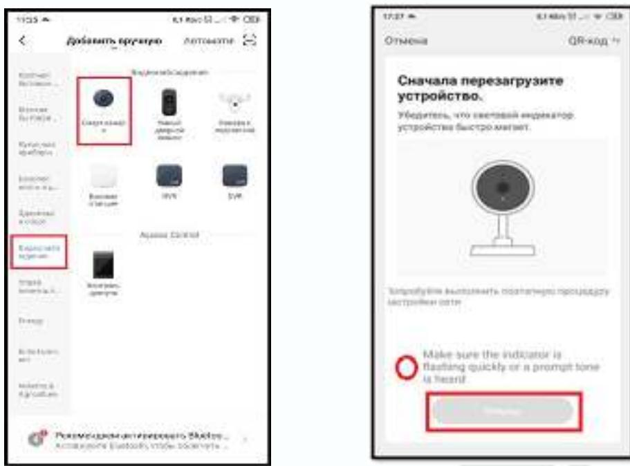
Перезагрузите камеру отключив её от питания и включив вновь. Примерно через минуту после включения, камера произнесет «**Wait for Wi-Fi Config**». Нажмите на подтверждающую надпись в нижней части экрана приложения о том, что индикатор быстро мигает или слышен звуковой сигнал. Нажмите **Вперед**.
