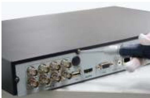
Рис. 2.1. Снятие крышки LTV RTM-040 00
