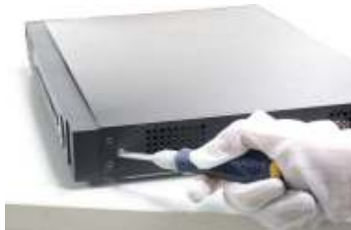
Рис. 2.1. Снятие крышки LTV RTM-040 00
