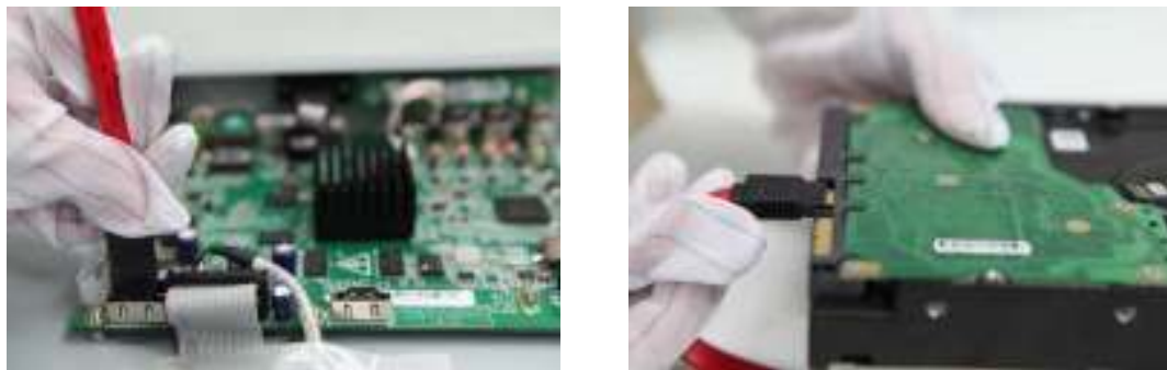
Рис. 2.2. Подключение кабеля данных
