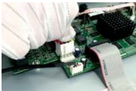
Рис. 2.3. Подключение кабеля питания
