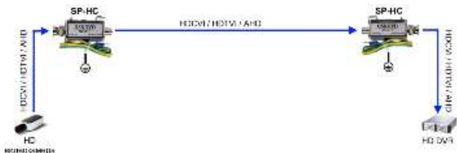
Рис.6 Типовая схема подключения устройства грозозащиты SP-HC
