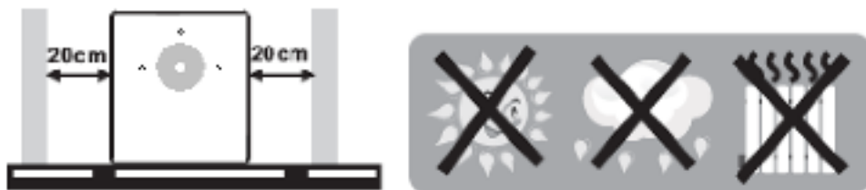
Figure 1. Posizionamento dell' UPS
