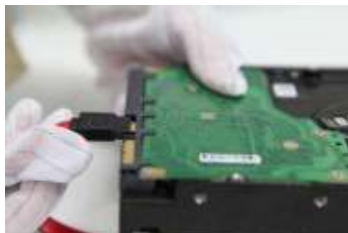
Рис. 2.2. Подключение шлейфа SATA
