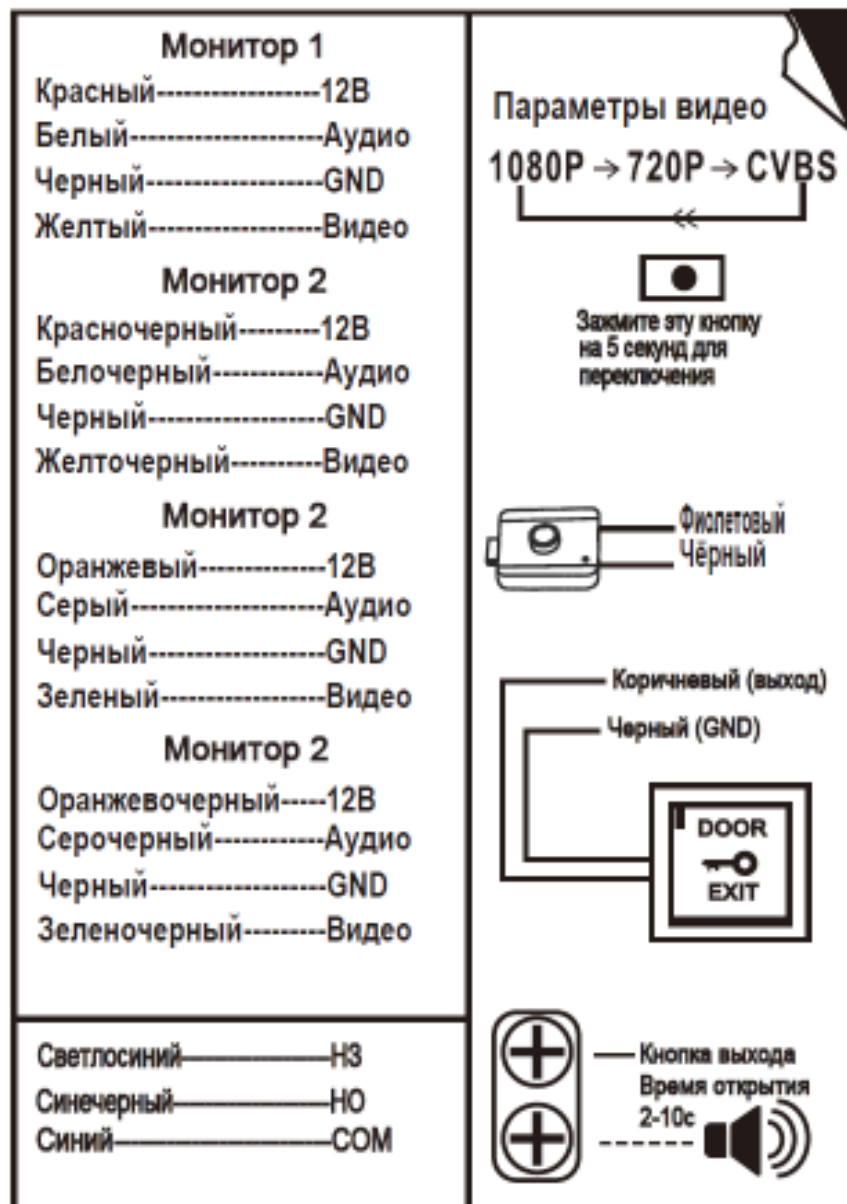
Рисунок 2. Соответствие цветов и назначения проводов вызывной панели.
