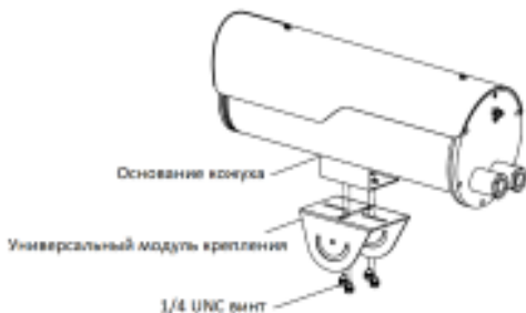
Рисунок 2-3 Установка камеры на модуль крепления
