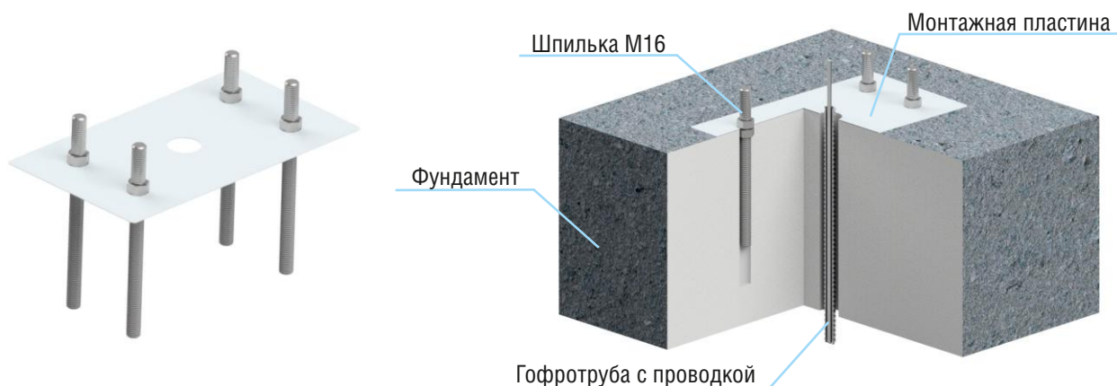
Рисунок 7.2.1 Устройство фундамента с монтажным комплектом
