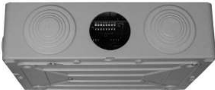
Рисунок 9 – Расположение DIP-переключателей контроллера
