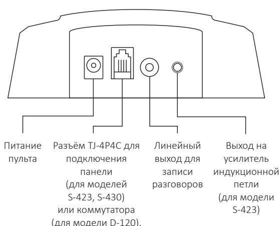
Назначение проводов разъёма TJ-4P4C для подключения пульта к панели клиента/посетителя или коммутатору:
