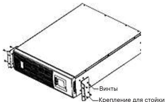
Рис. 4. Монтаж кронштейнов для установки в стойку
