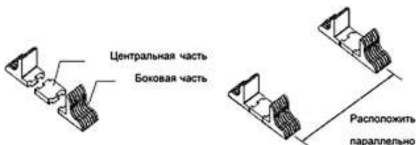
Рис. 2. Сборка и расположение опор
