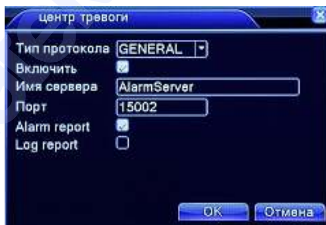
Рис. 4.11 Установки Центра тревоги
