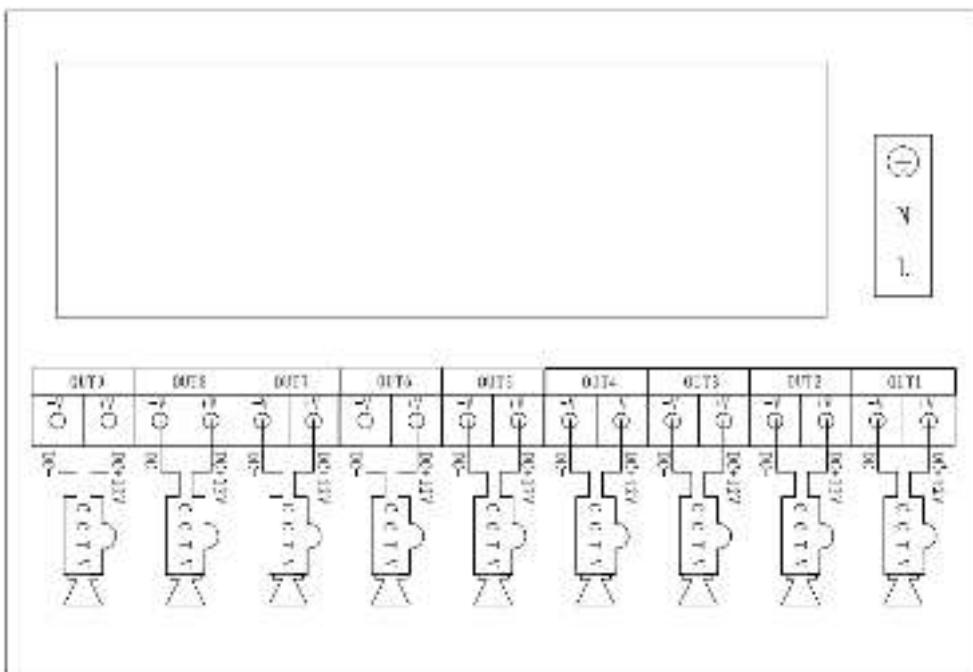
**Внимание!** Несоблюдение полярности подключения может привести к выходу из строя подключаемых устройств.
