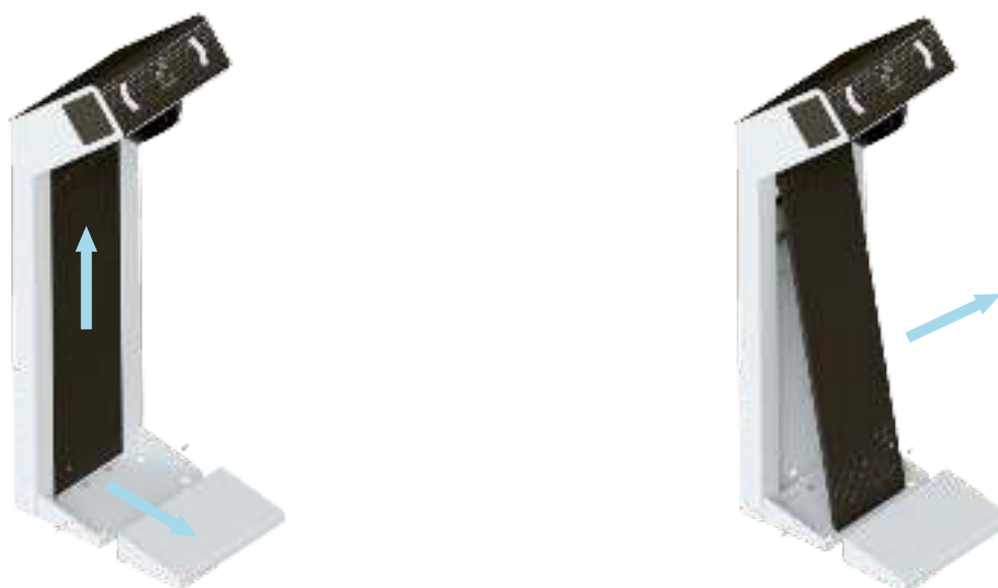
Рисунок 7.4.2 – Разборка кожухов турникета
