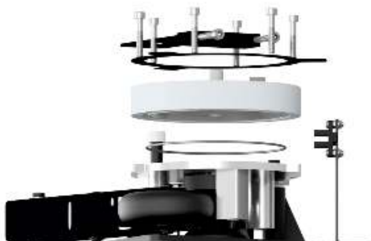
Рисунок 12.3.1 – Порядок замены уплотнительного кольца
