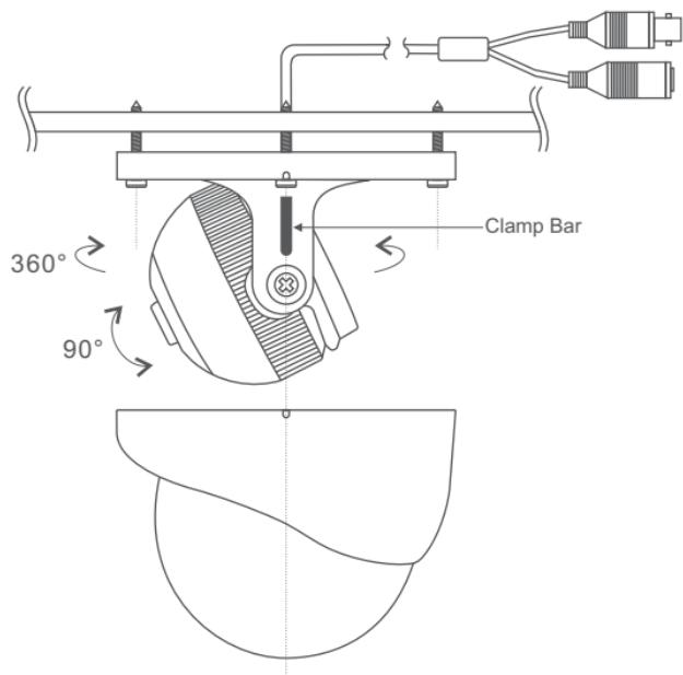
После настройки угла наклона камеры, для закрытия корпуса сначала совместите **Clamp Bar**, который представляет собой пластиковый выступ (смотри рисунок), с вертикальными направляющими на внутренней поверхности купола. Это позволит вращать модуль совместно с крышкой купола в горизонтальной плоскости. Соедините крышку купола с основанием в обратном порядке и затем направьте камеру в нужном направлении.
