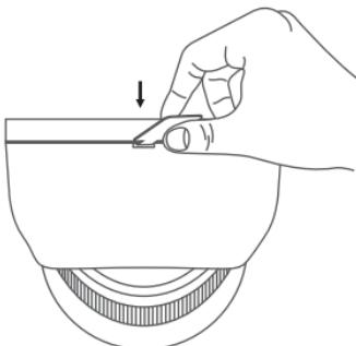
С помощью тонкой отвертки, подденьте край крышки купола, и он легко отделятся от основания.
