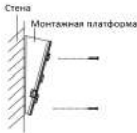
Рисунок 2-8 Установка наклонной монтажной платформы
