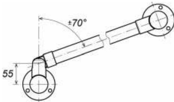
**Рисунок 12. Возможные углы поворота патрубка поворотного типа PERCo-BH02 0-11**
