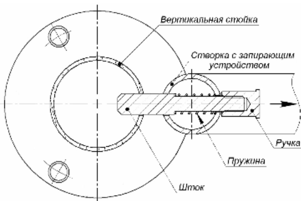
**Рисунок 15. Установка штока стопорного узла**
