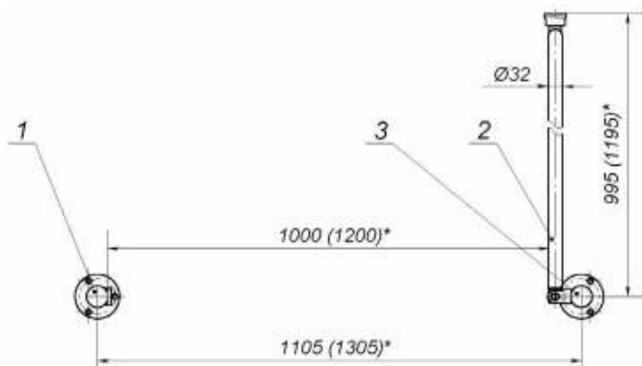
**Рисунок 7. Автоматическая поворотная секция ограждения с электромагнитным УБ в открытом состоянии<sup>1</sup>:**
