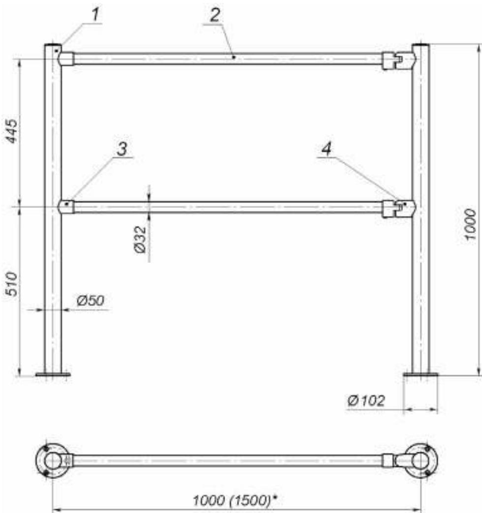
**Рисунок 3. Стационарная секция ограждения без заполнения с поворотными патрубками<sup>1</sup>:**
