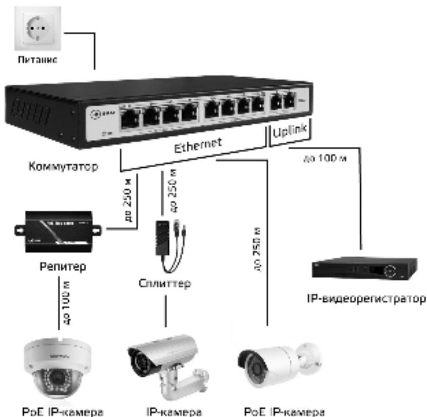
Рисунок 3 – общая схема подключения устройств к коммутатору
