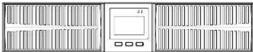
Figura 1 - Vista frontale dell'UPS SMALLR1, SMALLR2 e SMALLR3
