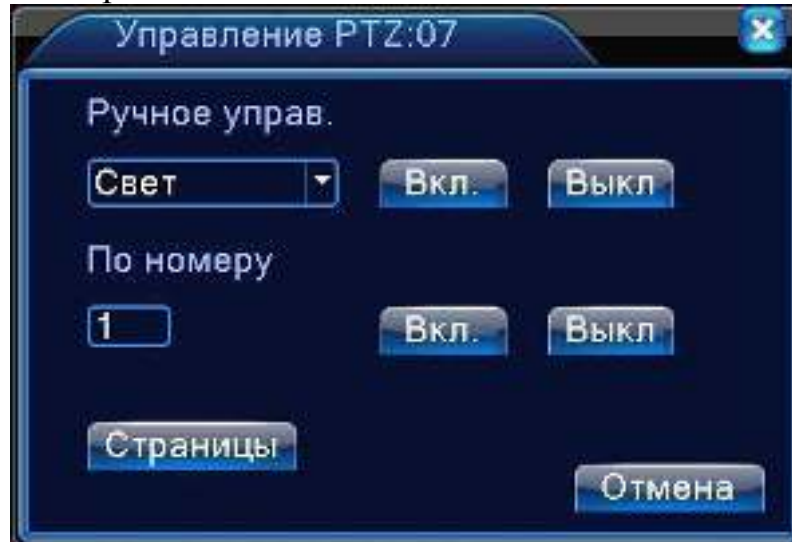
Рисунок 3.16 Управление вспомогательными функциями
