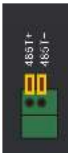
RS485 интерфейс 4 канального регистратора
