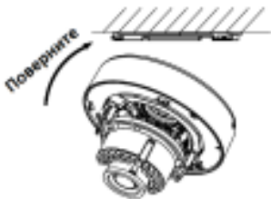
Рисунок 2.14 Установка камеры на потолок
