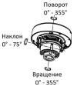
Рисунок 2.15 3-х осевая регулировка объектива
