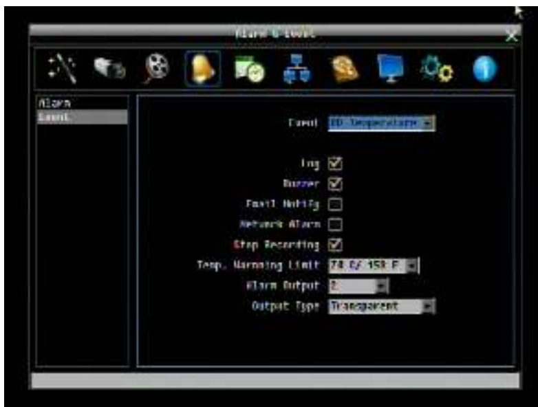
Рисунок 4-12 Меню Тревоги и События – Событие – Температура HDD
