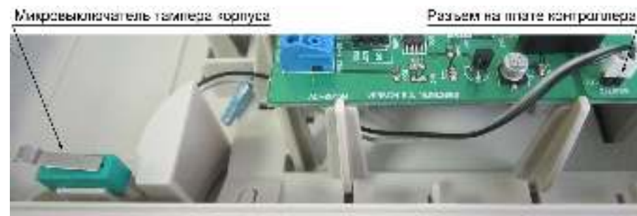
Рисунок 11. Подключение тампера корпуса
