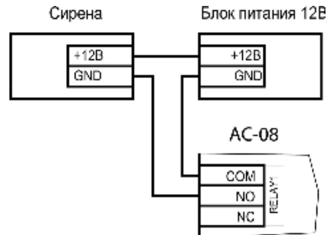
Рисунок 9. Подключение сирены к первому реле
