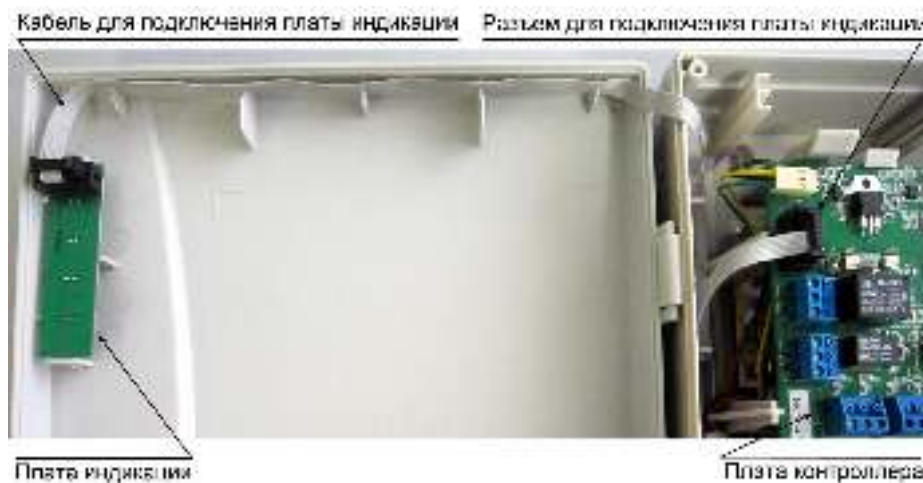
Рисунок 13. Подключение платы внешней индикации
