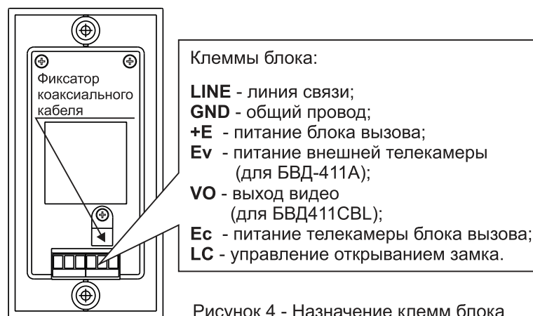
Рисунок 4 - Назначение клемм блока
