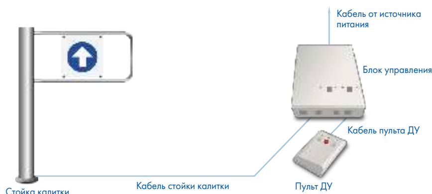
Схема подключения калитки PERCo-WMD-05S(SW)
