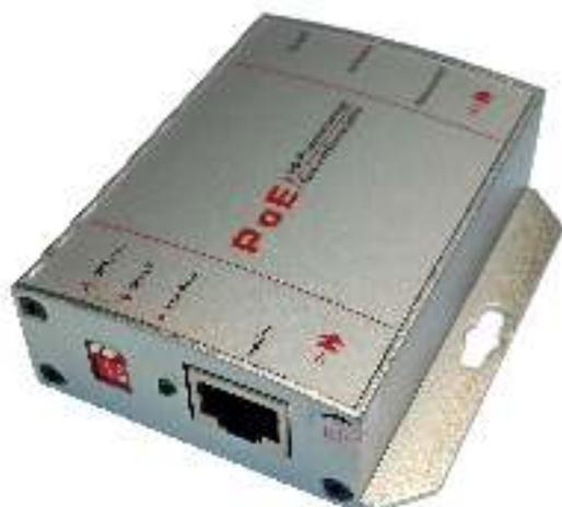
**Назначение :** *Разделение PoE линии на линию Ethernet и линию 5/12VDC (DIP1,2 вниз(ON) – 5В; DIP1,2 вверх(OFF) – 12В)*
