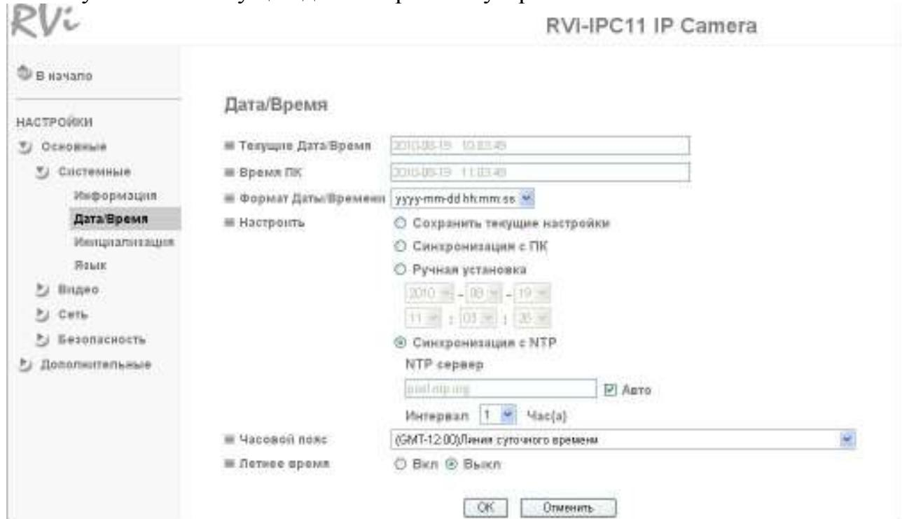
**Текущие Дата/Время:** данный пункт отображает текущие дату и время IP-камеры. **Время ПК:** текущие дата на время, установленные на компьютере, с которого происходит обращение к IP-камере. **Формат Даты/Времени:** позволяет выбрать формат отображения даты и времени на экране.
