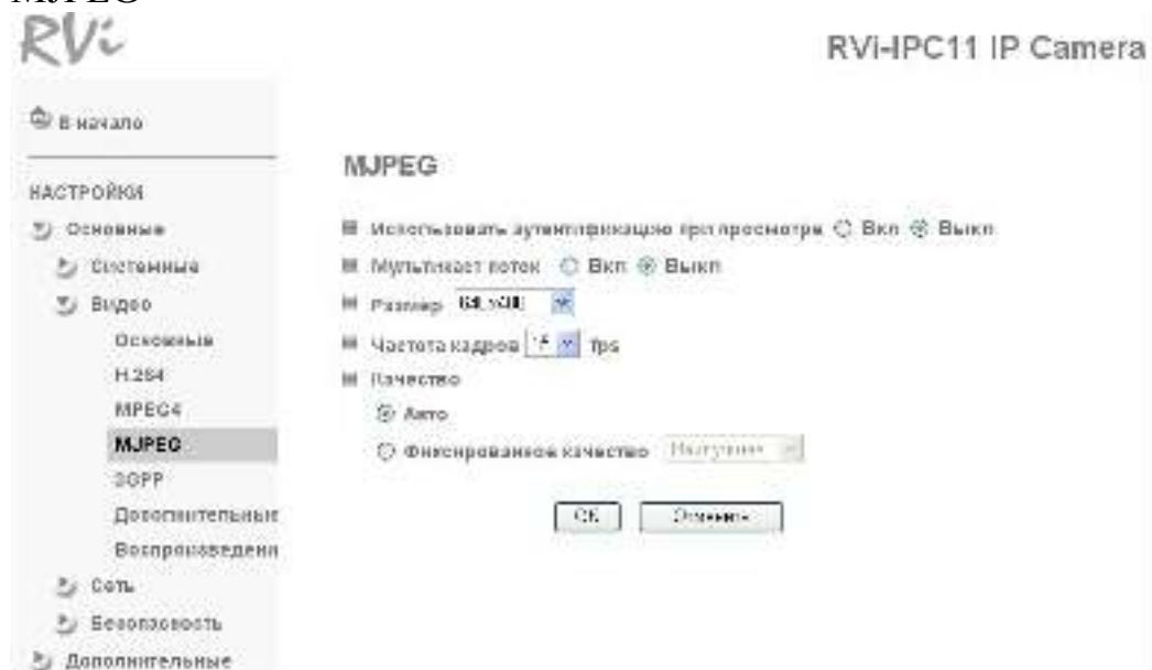
**Использовать аутентификацию при просмотре:** При включении аутентификации пользователь должен указать Имя пользователя и Пароль для просмотра видео при помощи стороннего плеера, такого как Quick Time.
