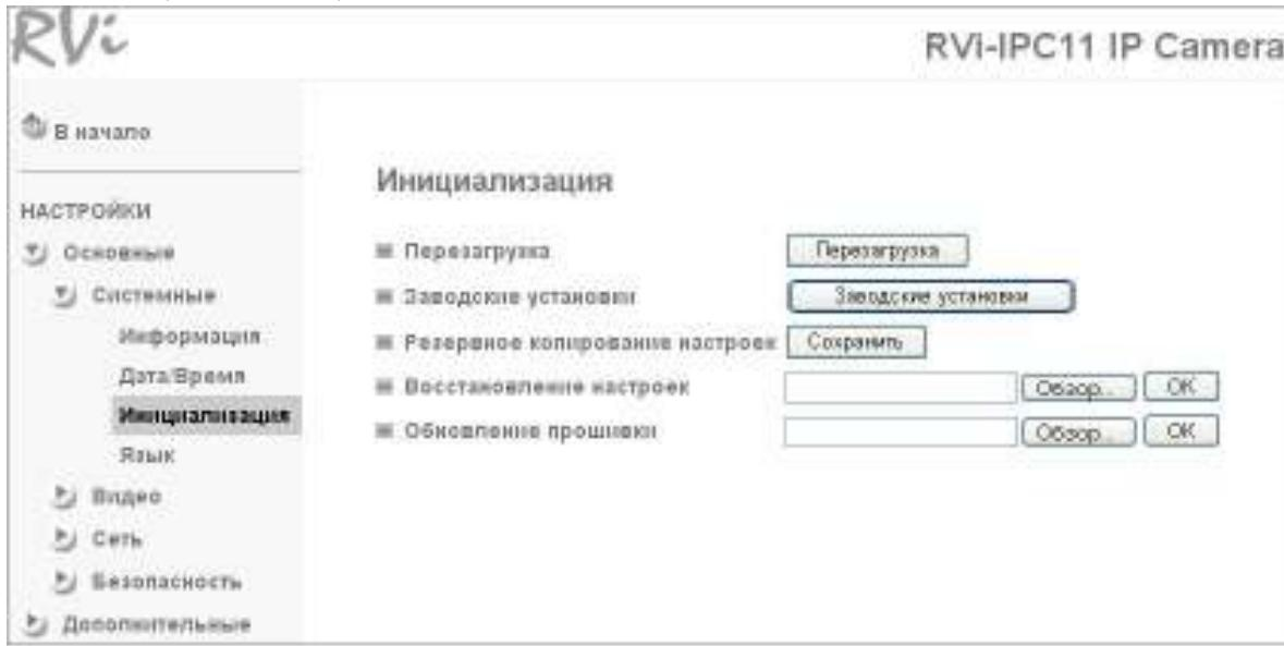
**Перезагрузка:** при нажатии этой кнопки происходит перезагрузка IP-камеры. Процесс перезагрузки может занимать до 3 минут.
