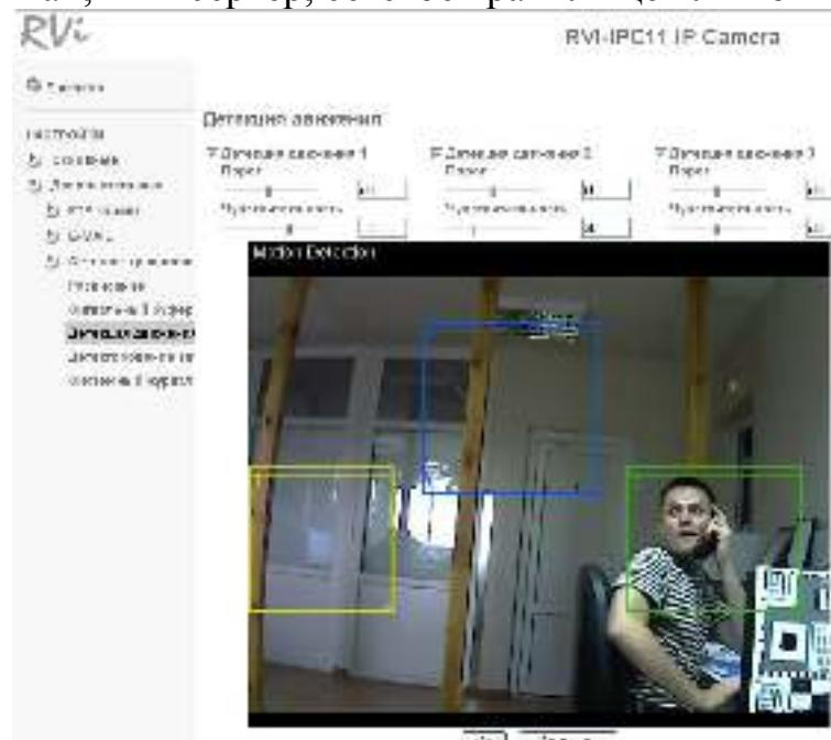
**Порог:** Вы можете установить порог срабатывания детектора движения для каждой области детекции.
