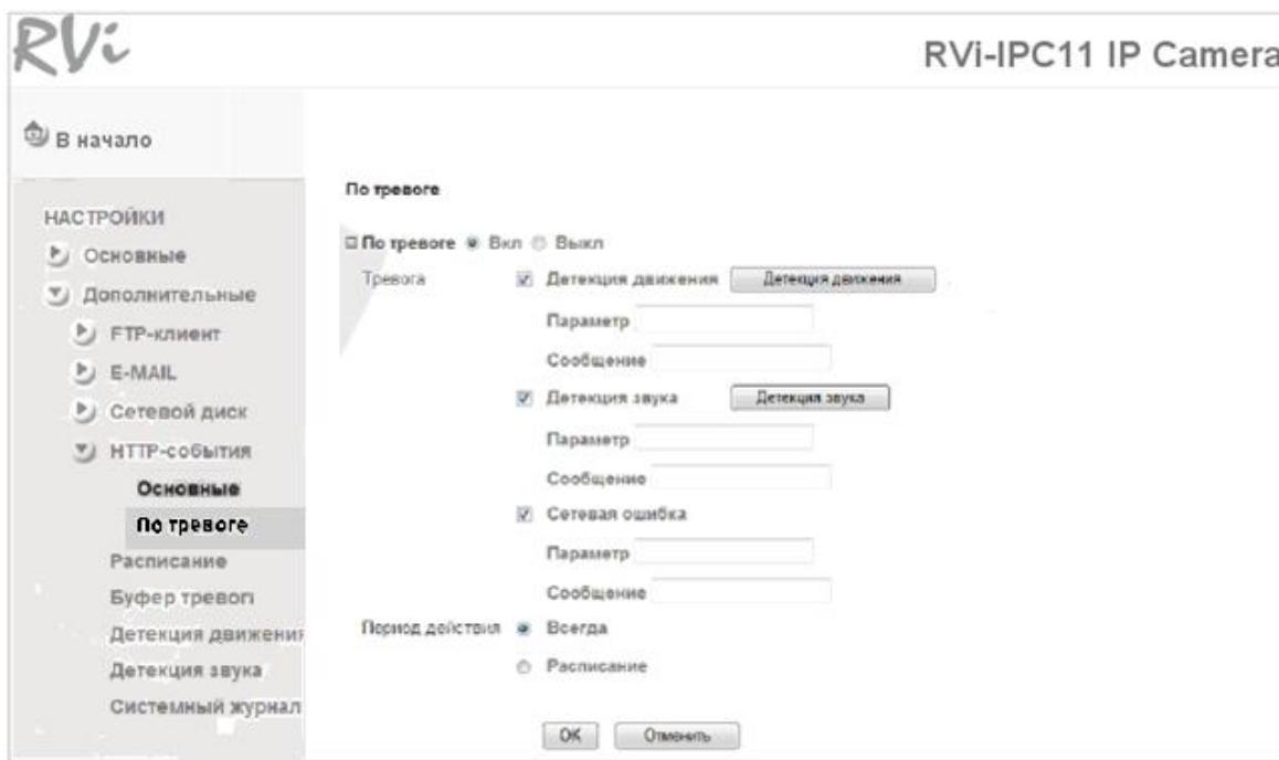
**Детекция движения:** Разрешает работу с HTTP-сервером при детекции движения. Параметры детекции движения можно настроить в данном меню при его активации.
