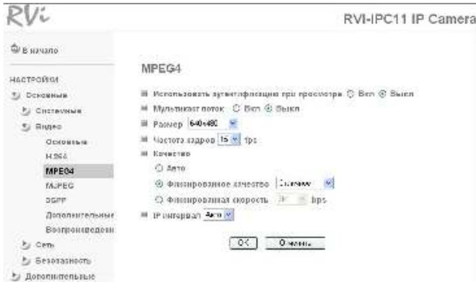
**Использовать аутентификацию при просмотре:** При включении аутентификации пользователь должен указать Имя пользователя и Пароль для просмотра видео при помощи стороннего плеера, такого как Quick Time.
