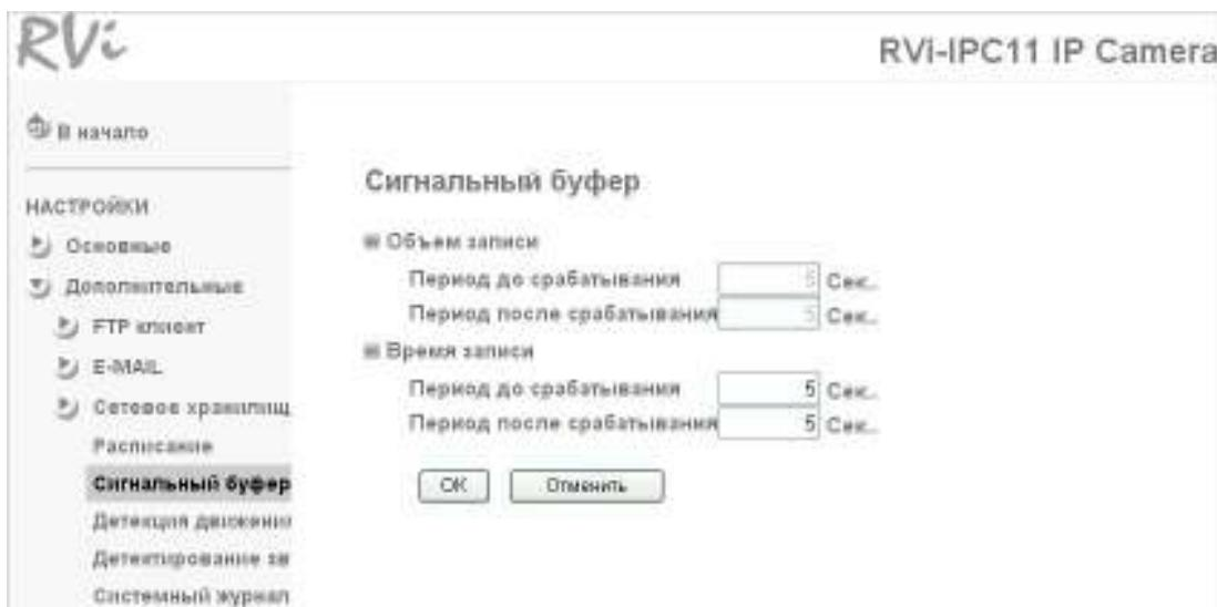
**Предзапись:** Устанавливается время записи до возникновения тревожного события (например, детектора движения, звука и т.д.) в пределах от 1 до 5 секунд.
