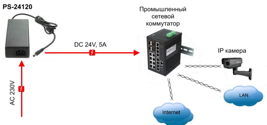
Рис.3 Типовая схема подключения блока питания PS-24120
