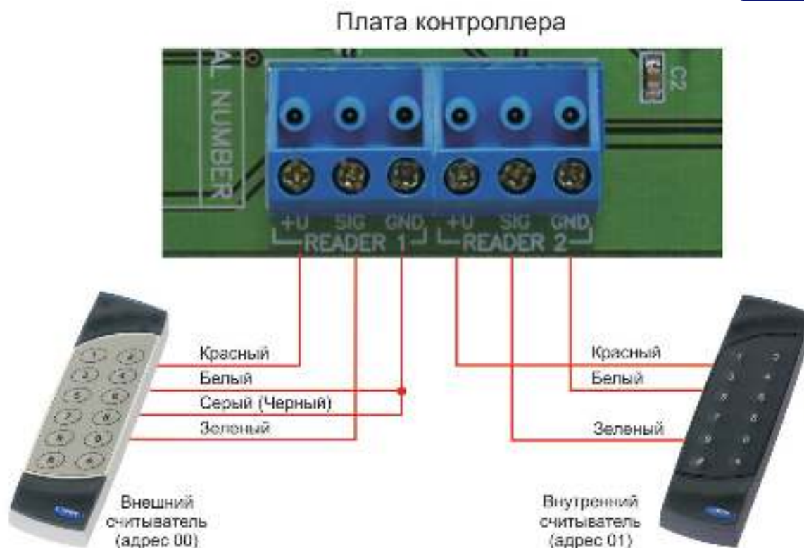
Рисунок 86. Подключение считывателей серии NR-xxx к контроллерам NC-1000/NC-5000.
