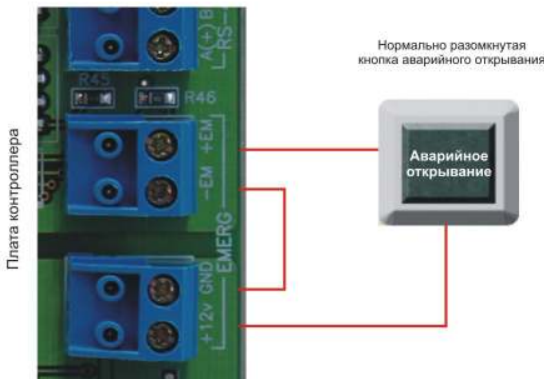
Рисунок 18. Подключение аварийной кнопки к одному контроллеру.
