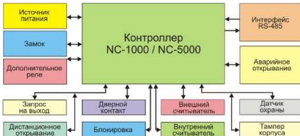
Рисунок 7. Оборудование, подключаемое к контроллерам NC-1000 / NC-5000.
