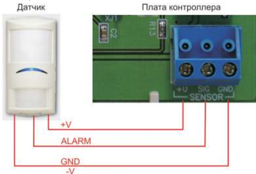
Рисунок 15б. Подключение охранного датчика без контроля подводящих проводов.
