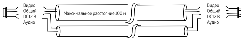
Рис. 8 Комбинированный видеокабель для подключения видеодомофона
