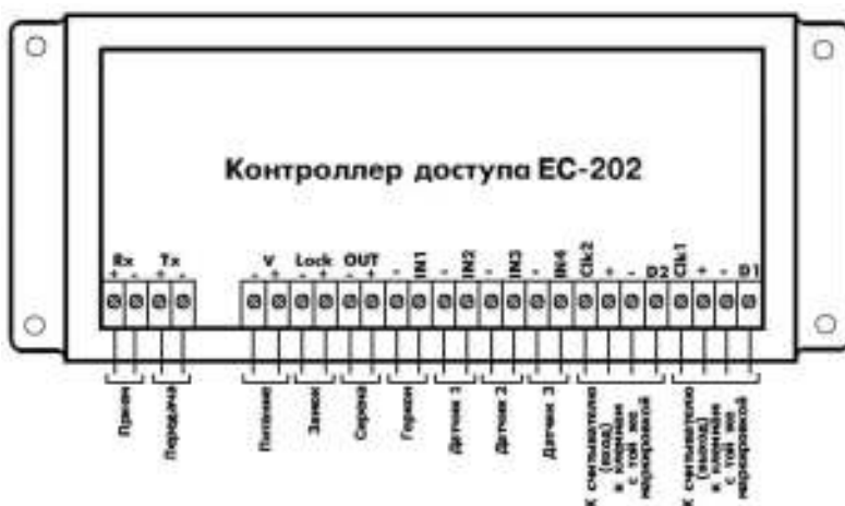
Рисунок 2 – Одна дверь, два считывателя
