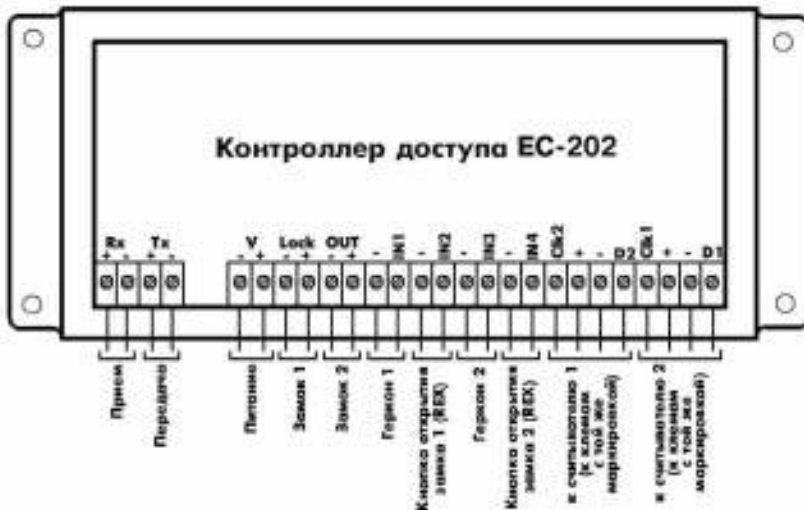
Рисунок 3 – Две двери, два считывателя
