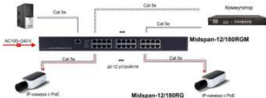
Рис.7 Схема подключения инжекторов на примере Midspan-12/180RG
