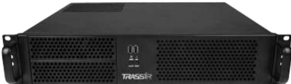
**TRASSIR NeuroStation Compact RE** – сетевой видеорегистратор для IP-видеокамер под управлением TRASSIR OS (Linux) с поддержкой видеоналикти на основе нейронных сетей: детекция проникновения людей в зону, подсчет количества людей в зоне (например, в очереди), а также поиск в архиве по людям. Поддержка Offload-аналитики (прием и обработка изображений передаваемых с других серверов TRASSIR).
