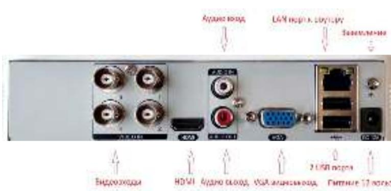
На задней панели регистратора расположен разъем питания, разъемы BNC, разъемы USB, разъем RJ45, RS-485 (опция), VGA, HDMI, входы/выходы тревоги (опция), входы/выходы звука (опция).
