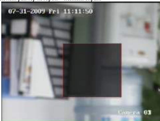
Рис. 14. Настройка зоны определения подделки видео.
