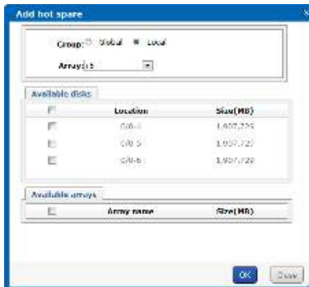
Рисунок 6. 17 Добавление локальной горячей замены
