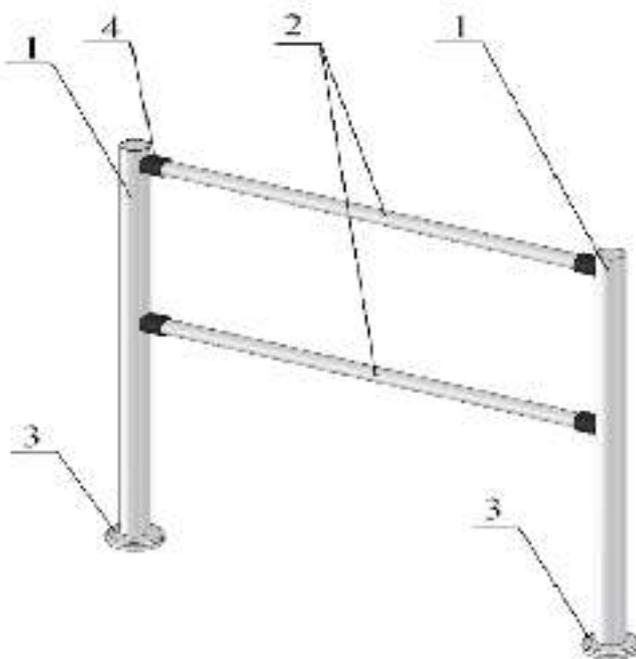
**1 – Стойка** из стальной трубы с хромированным покрытием диаметром 50мм.
