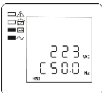
Рисунок 7 — ЖК-дисплей, Фаза С, входное напряжение и частота
