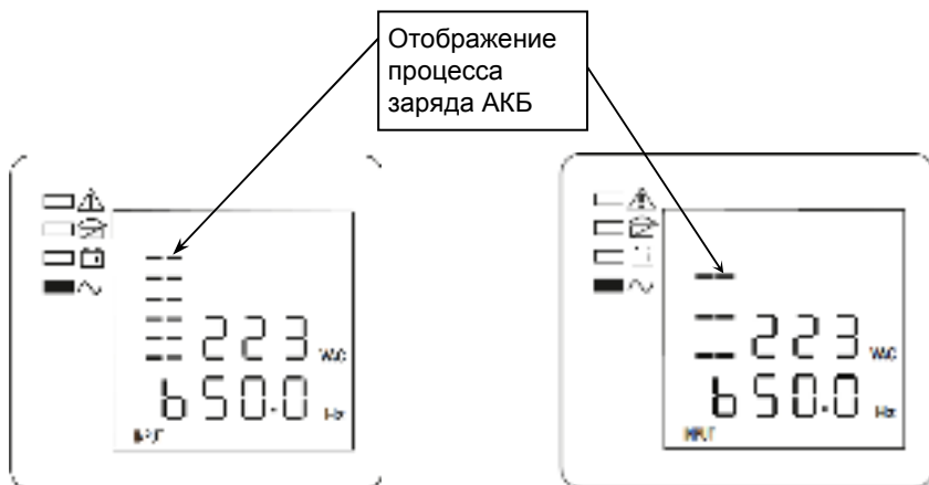
Рисунок 21 — ЖК-дисплей, форсированный (ускоренный) заряд АКБ
