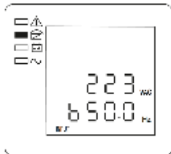
Рисунок 6 — ЖК-дисплей, Фаза В, входное напряжение и частота
