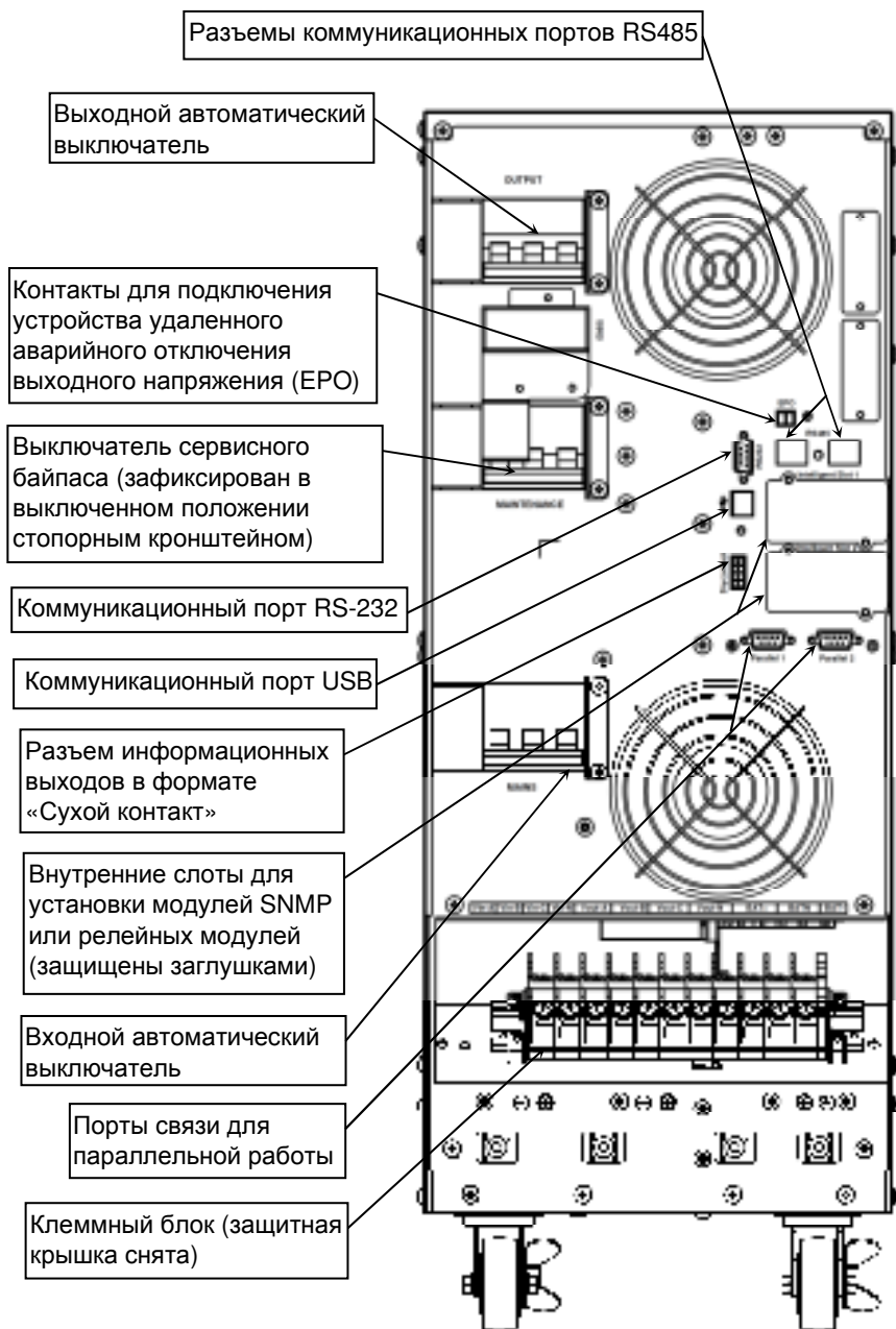
Рисунок 2 — Общий вид задней панели изделия со снятой крышкой клеммного блока
