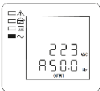
Рисунок 11 — ЖК-дисплей, Фаза А, выходное напряжение и частота
