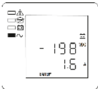
Рисунок 9 — ЖК-дисплей, отрицательная группа АКБ, напряжение и ток
