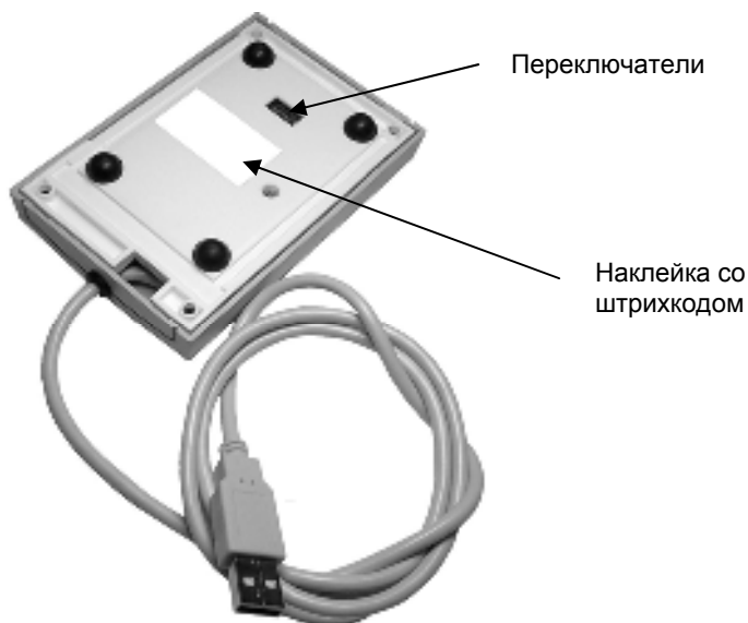
Рисунок 4 – Вид на переключатели с обратной стороны считывателя
